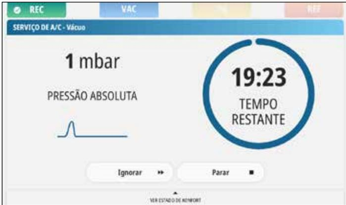
Fase de vácuo: Um vácuo é induzido no ar-condicionado do veículo para verificar se há vazamentos.
