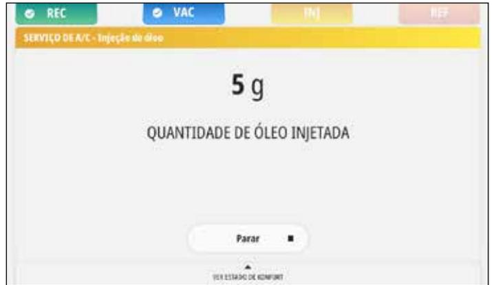
Fase "injeção de óleo": o sistema injeta a quantidade correta de óleo no sistema do veículo para lubrificar o próprio sistema.
