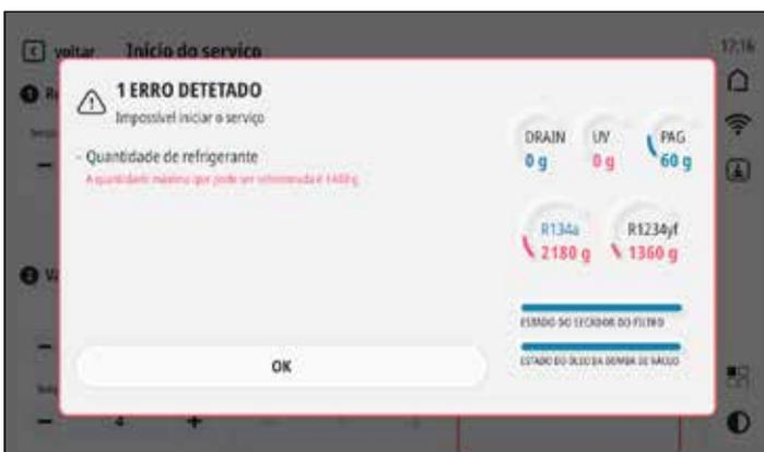
Exemplo de um erro detectado: KONFORT TOUCH detectou uma falha, neste caso a quantidade de refrigerante não é suficiente.
