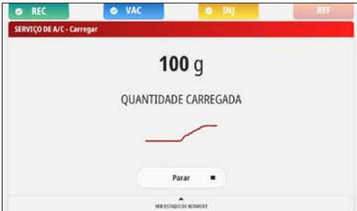
Fase "Carga de refrigerante": a estação fornece a quantidade correta de gás ao sistema do veículo.
