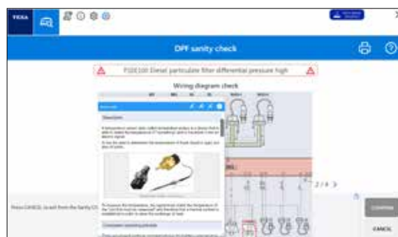
Procedimentos de diagnóstico adicionais para auxiliar na solução de problemas do erro, como diagramas de fiação, folhas de dados ou outras informações úteis.
