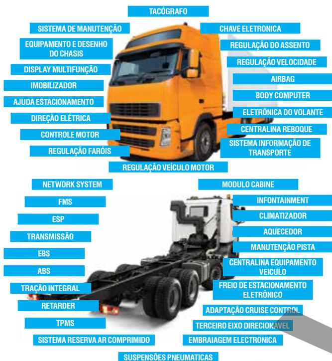
Figura 11: Sistemas eletrônicos Veículos industriais
