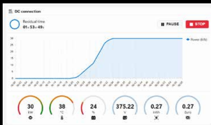
Serviço de recarga em modo DC com mensagens de status
